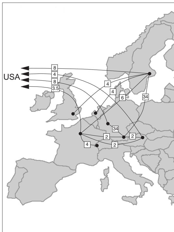
Abb. 2: Ebone-Backbone (Zahlenangaben der Leitungsgeschwindigkeiten in Mbit/s)
