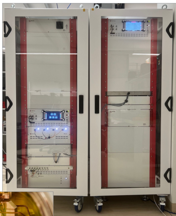
oben: optische Ytterbium-Atomuhr am BEV-Standort Arltgasse 35, 1160 Wien links: Aufnahme der Einzel-Atom-Falle im Inneren der Anlage (Fotos: Thomas Riebner, TU Wien/BEV)
