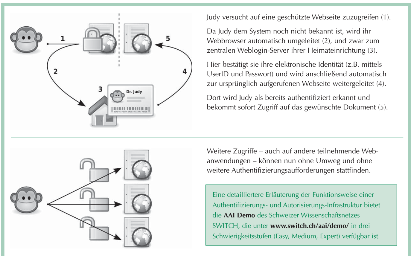
Abb. 1: Vereinfachte schematische Darstellung der Nutzung eines WebSSO-Systems
